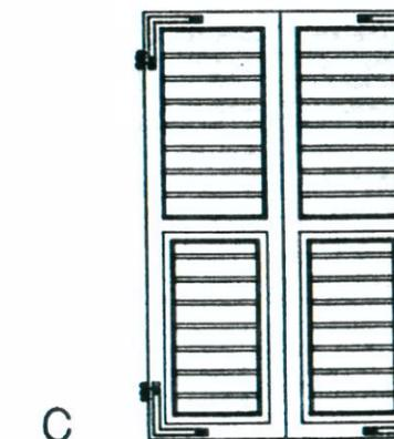
Finestra : Telaio fisso, traverse e montanti con incastro, bacchette fermavetro composte. Ferramenta con cerniere angolari e chiusure con garagi, naticchia o spagnoletta.
